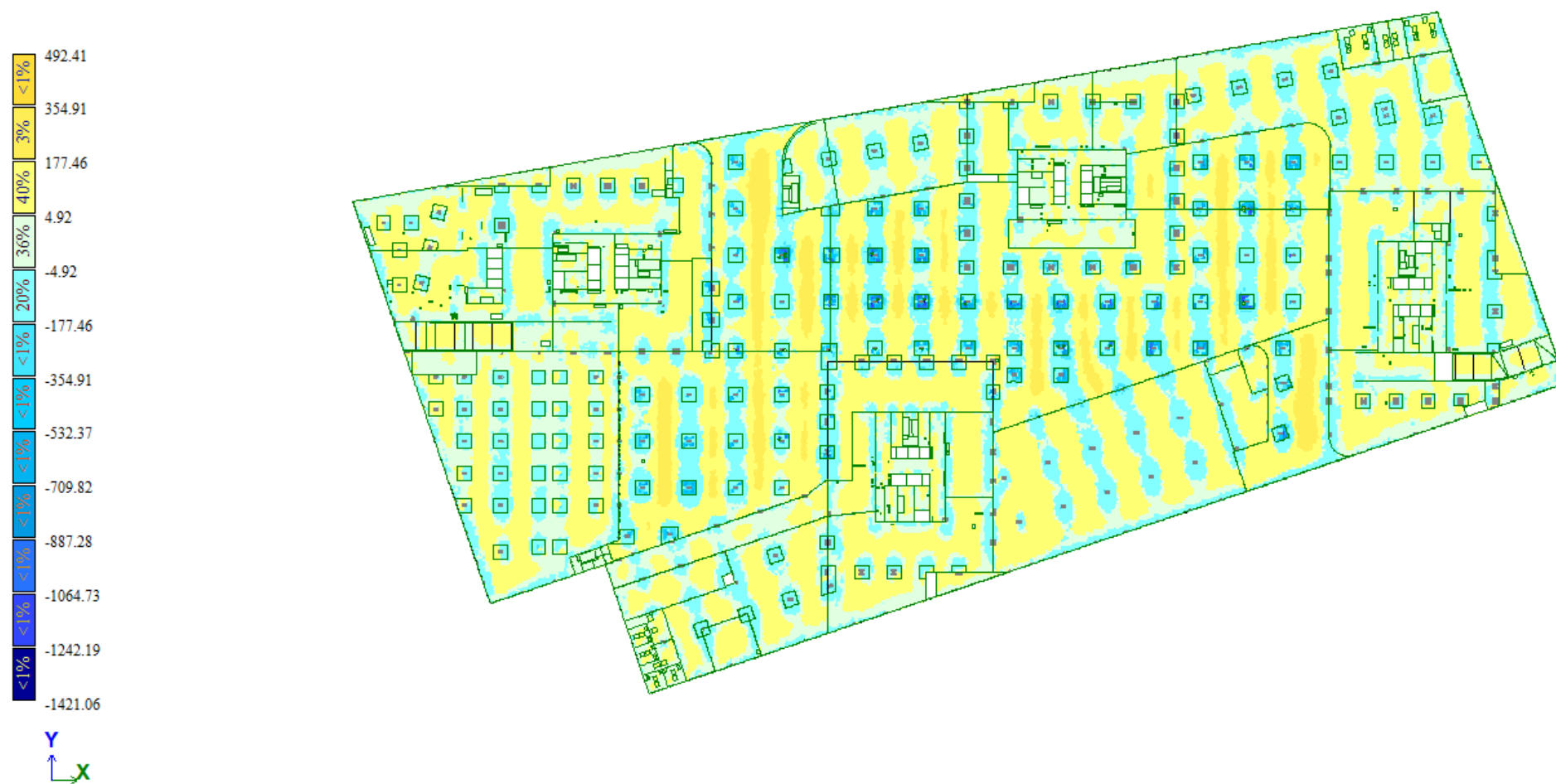
Рис. П8.6 Плита перекрытия, 1 этаж. Мозаика напряжений по Mx
